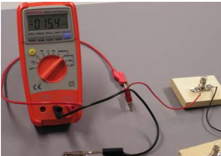
Här mäter vi strömmen genom en glödlampa. För att lyckas med detta måste samma ström som går genom glödlampan gå genom DMM-en
