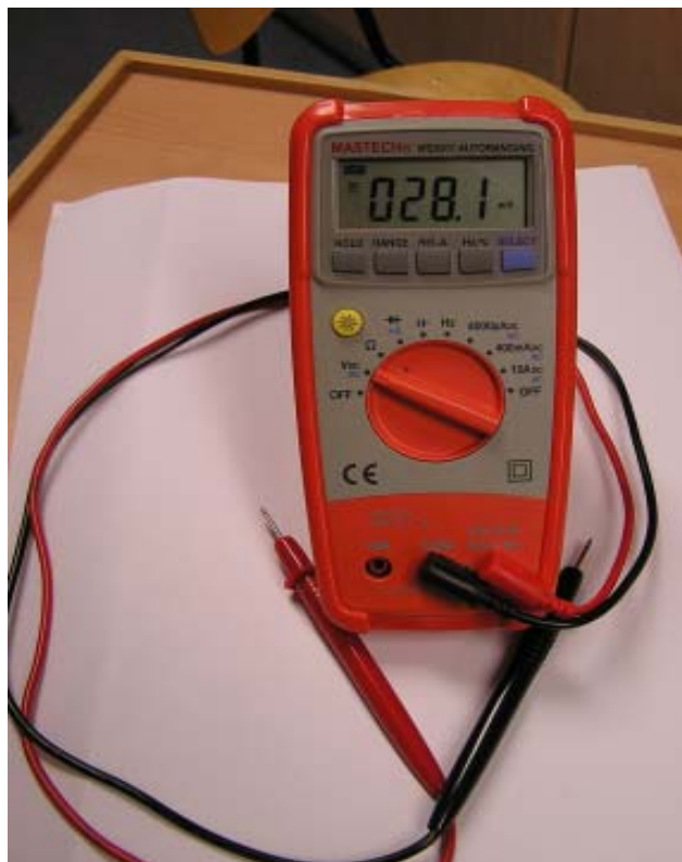
DigitalMultiMetern har en display, en huvudratt för val av funktion och tre anslutningar. Två sladdar krävs för en mätning.
