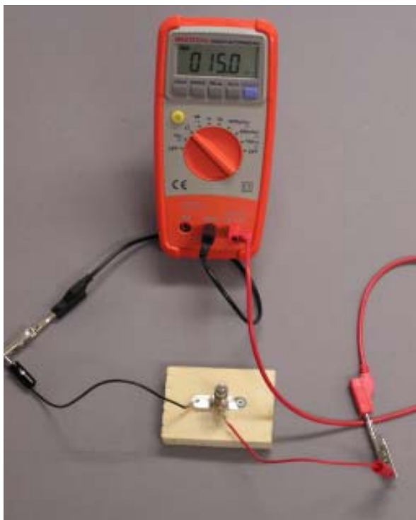
Här mäts resistansen hos en glödlampa med hjälp av en DMM.
